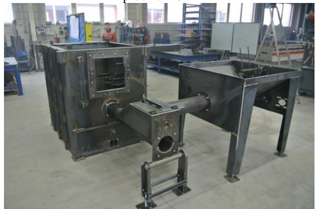
Obr. 3 - Čelní pohled na ocelový svařenec spalovací komory kotle s připojeným šnekovým dopravníkem a zásobníkem na palivo.
