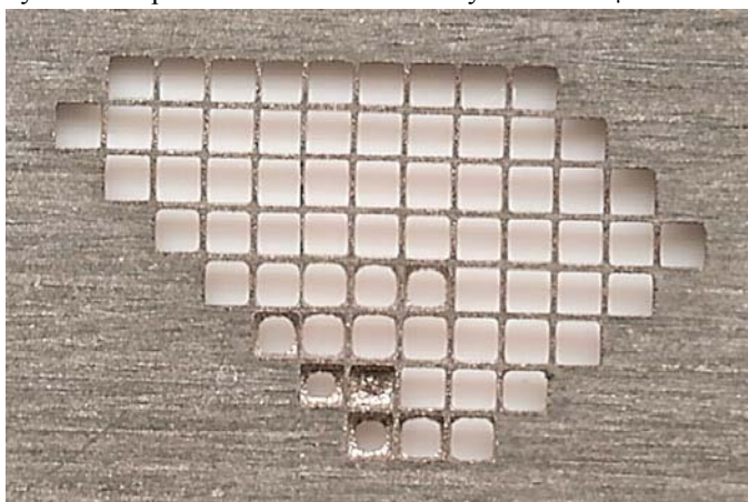
Obr 4. Mřížka vyhloubená pomocí čtvercové elektrody
