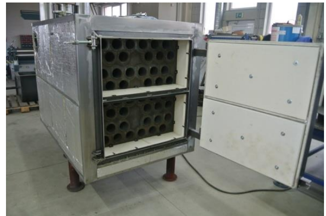
Obr. 2 - Výměňková část – žárotrubný výměník, stav v prosinci 2012
