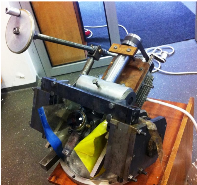
Fig. 4. Stroj na obrábění progresivních čoček s evolventním profilem.
