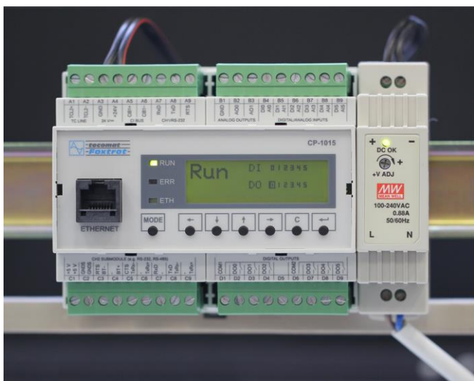
Obr. 6. Programovatelný automat PLC Tecomat Foxtrot CP-1015 s napájecím zdrojem osazený na DIN liště.
