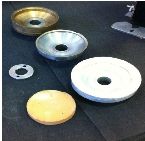
Fig. 5. Nástroje odshora na broušení, frézování, leštění.
