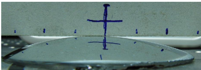
Fig. 6. Sagitální (kvazihyperbolický) profil čočky a jeho vyhodnocení.
