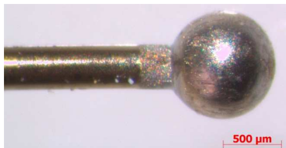
Obr. 6. Kulička nataveného NiTi – povrch bez oxidů (proud 5 A, Ar 5 l/min, umístěno v ochranné trubičce)
