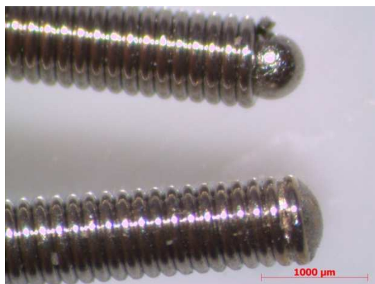
Obr. 10. Heterogenní svar – 10 A, Ar 10 l/min
