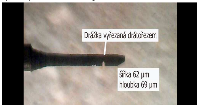
Obr. 4. Řezání drážky do válcové elektrody
