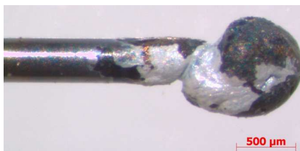
Obr. 5. Kulička nataveného NiTi – oxidovaný povrch (proud 5 A, Ar 5 l/min, ochrana u ústí ochranné trubičky)
