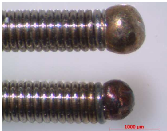
Obr. 8. Heterogenní svar – 5 A, 5 l/min, ruční svařování
