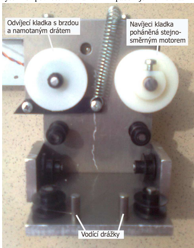
Obr. 3. Vlastní přípravek vyrobený pro tvarování elektrod
