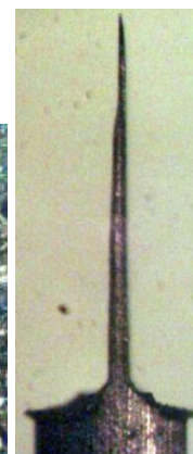
Obr. 2: Nosník o šířce 31 \mu\text{m} – vlevo, drážka o šířce 25 \mu\text{m} – uprostřed, elektroda o tloušťce 13 \mu\text{m} – vpravo.
