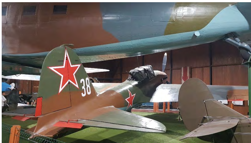
Obr. 2.: Iljušin Il-2m3 Šturmovik, Motor: AM-38F o výkonu 1 250 kW; rozpětí: 14,60 m; délka: 11,65 m; hmotnost prázdného letounu: 4 525 kg; vzletová hmotnost: 6 360 kg; maximální rychlost: 404 km/h; dostup: 3 500 m; dolet: 765 km [3]
