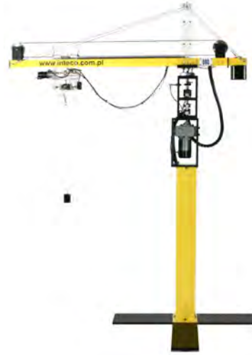
Obrázek 1: Laboratorní model věžového jeřábu od firmy INTECO [4]
