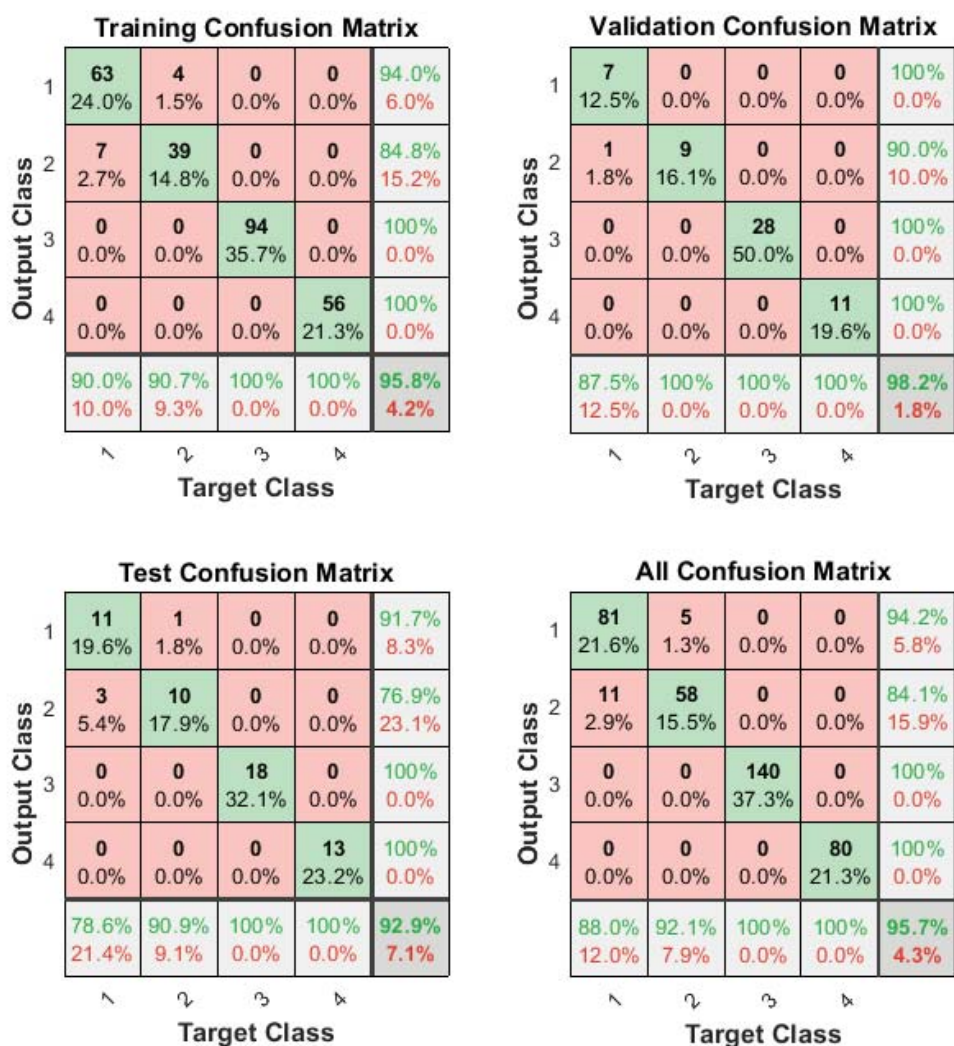
Obr. 8 Původní data, původní nastavení Matlabu (263 trénovacích, 56 validačních i testovacích, 10 neuronů ve skryté vrstvě, Matlab provedl 20 iterací). Výsledek je prakticky stejný, resp. rozdíl může být dán stochastickým charakterem metody.
