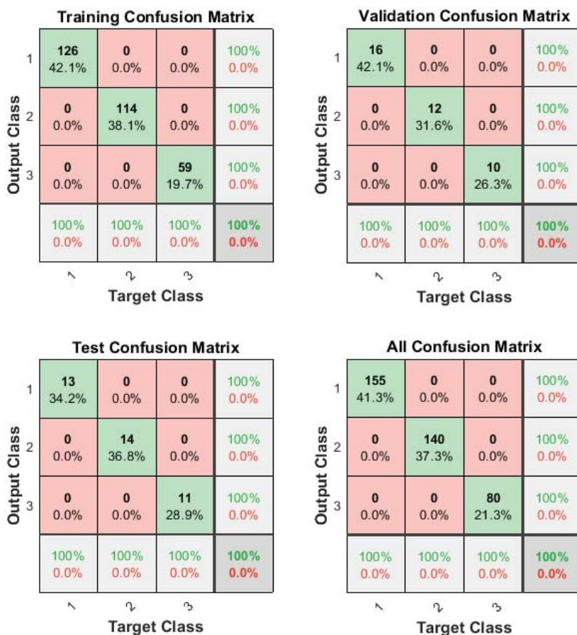
Obr. 7 Po sloučení hlásek "a" a "e" do jedné skupiny máme naprosto bezchybné rozpoznávání.
