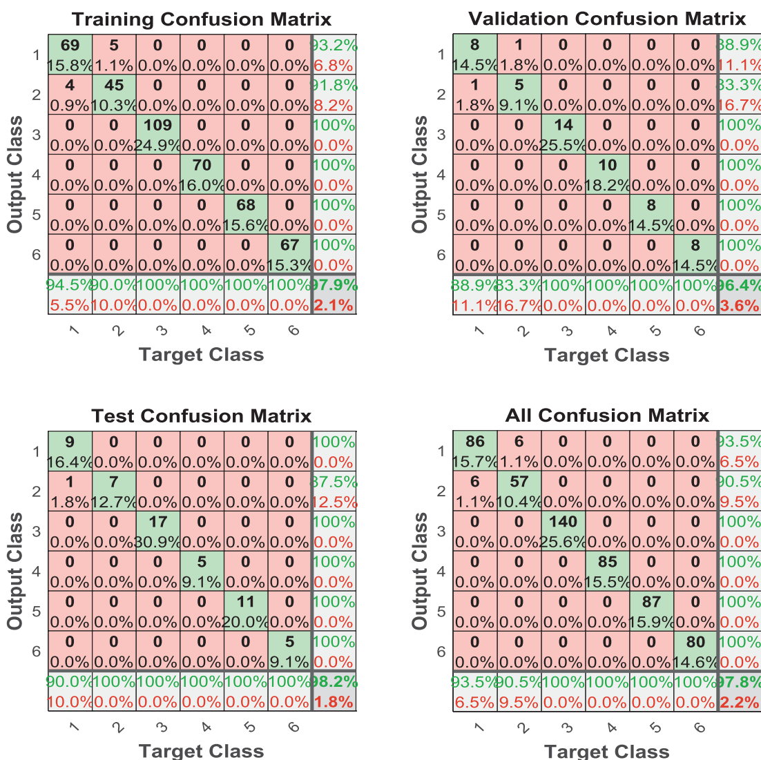
Obr. 9 Úplná sada dat (1=a, 2=e, 3=i, 4=o, 5=u, 6=s). Výsledky jsou obdobné. Celý soubor má 576 řádek, ty se dělily na 437 trénovacích, 55 validačních a stejný počet testovacích. Skrytá vrstva byla nastavena na 21 neuronů. Proběhlo 46 iterací. I v tomto případě nejsou rozpoznány hlásky „a“ a „e“, zatímco ostatní jsou bezchybně rozlišeny.
