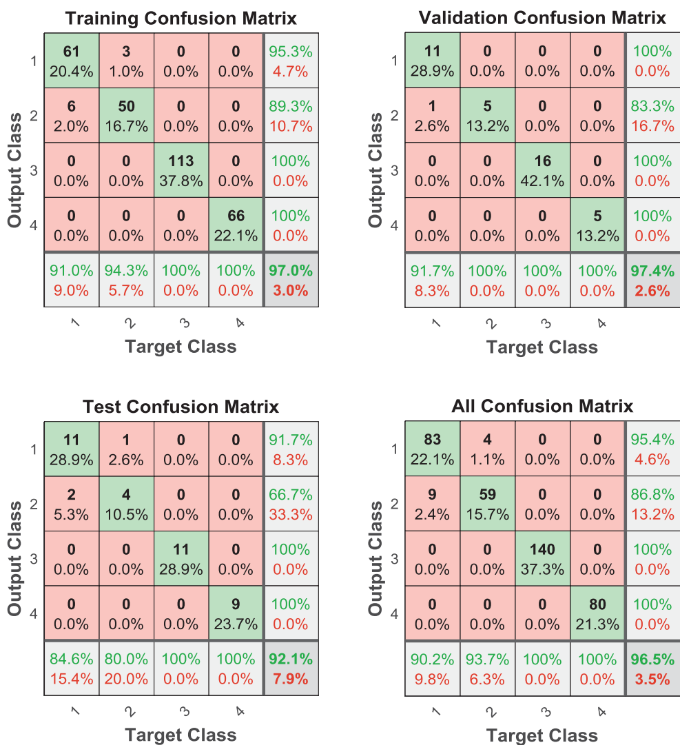
Obr. 6 Výsledky trénování. Svisle výsledek klasifikace, vodorovně správná hodnota. Dochází jen k záměnám hlásek „a“ a „e“, což může být poměrně hrubým rozdělením začátku frekvencí.
