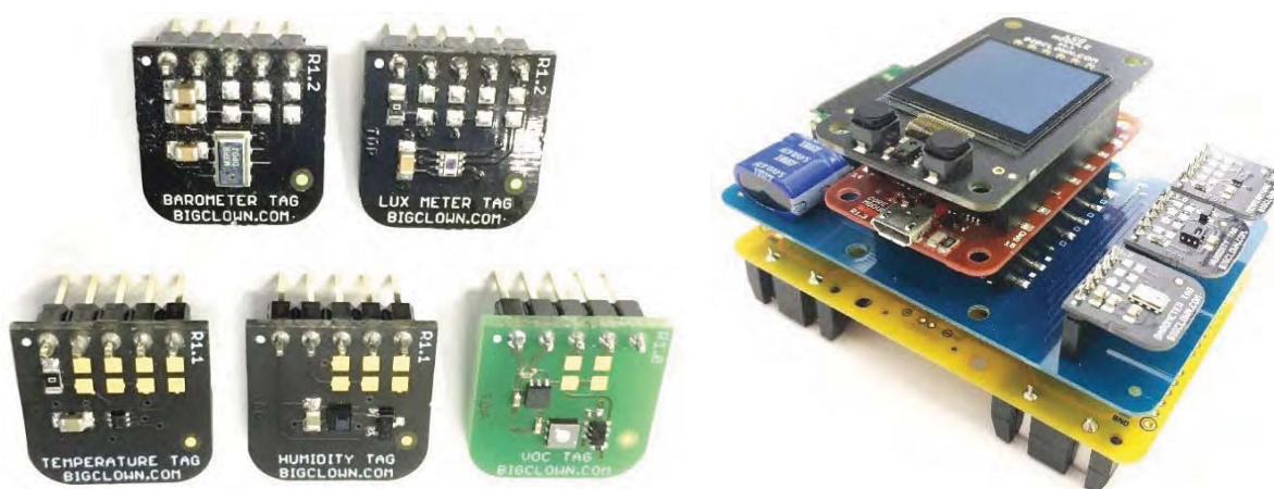
Obr. 2: Vlevo: základní senzory prostředí modulárního IoT systému BigClown firmy Hardwarío. Vpravo: Příklad sestavy pro měření teploty, barometrického tlaku, relativní vlhkosti a koncentrací CO 2 vybavené bateriovým modulem a displayem.
