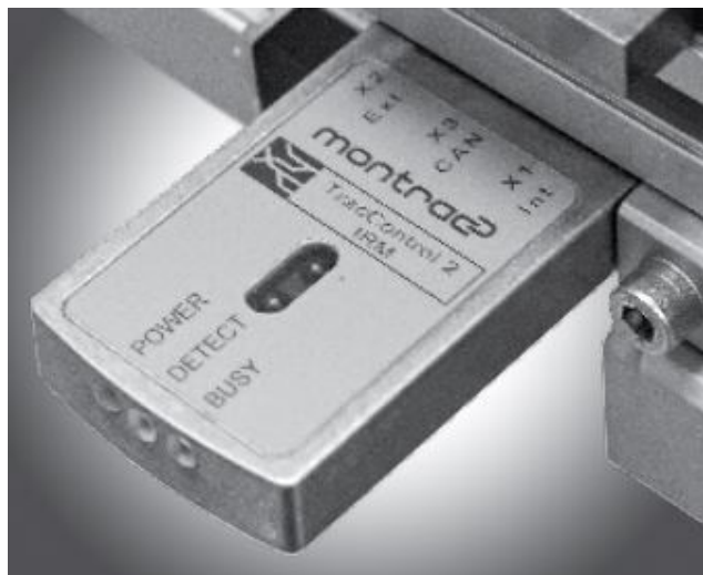
Obrázek 2.4: Ukázka optoelektronického čidla IRM [2]
