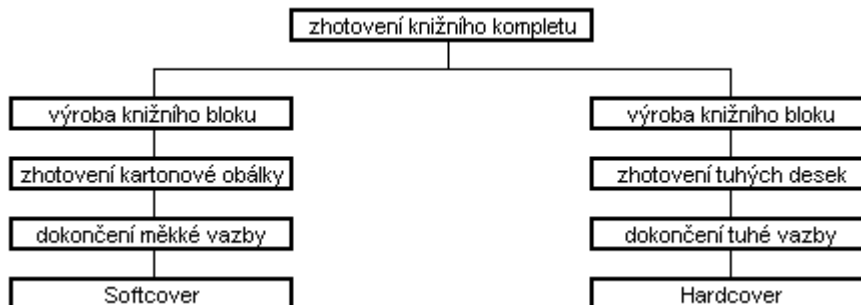
Obr. 2.5-4 Porovnání technologie výroby měkké a tuhé vazby
