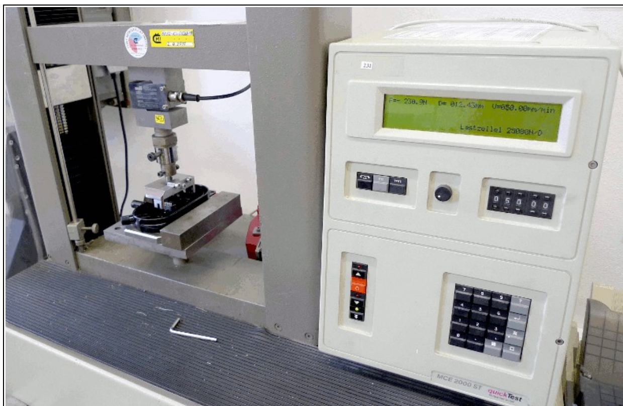
Obrázek 2: Trhací stroj při měření lisovací síly.
