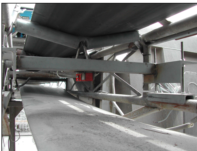
Obr. 1.2: Měřicí úsek pásové váhy
